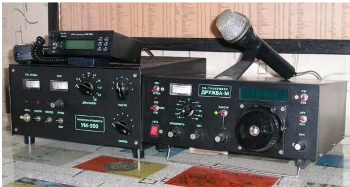
Рис.2.6. Трансивер «Дружба-М» и усилитель мощности «УМ-200»
